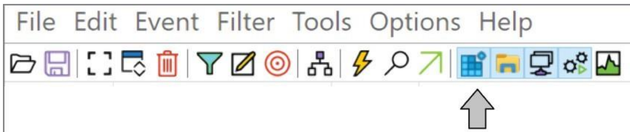
Рисунок 10.4: Фильтрация по событиям реестра в Process Monitor
